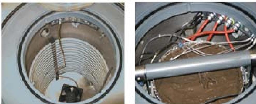
**Fig 8.1 – Immagini del liofilizzatore Gamma 1-20, vuoto e contenente i piatti con i sedimenti da trattare.**
