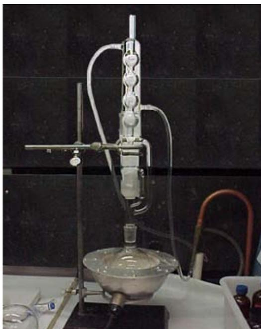
Fig 8.2 – Immagine dell'apparato per estrazione Soxhlet.
